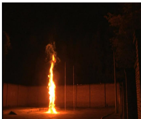
40Kg 桶装硝化棉燃烧实验
