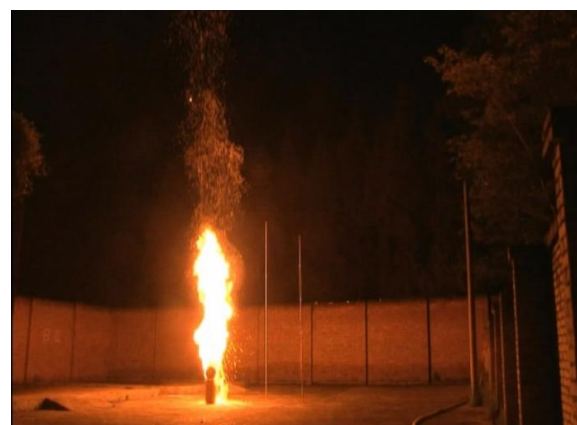
40Kg 桶装硝化棉燃烧实验
