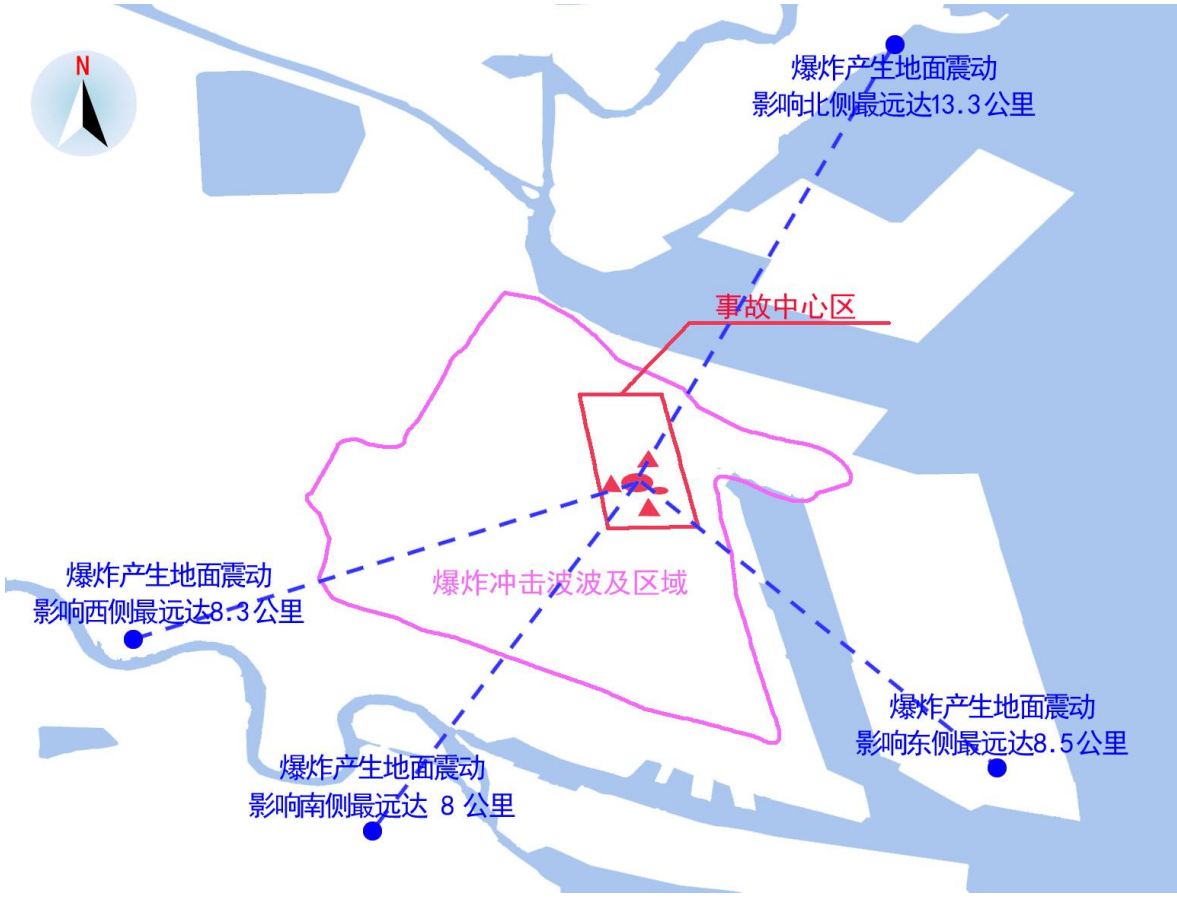
图4 爆炸冲击波波及区示意图
